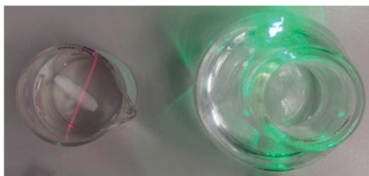
Рисунок 3. Золи наносеребра, полученные полиглюкановым методом (а); серия разбавлений наиболее интенсивно окрашенного золя (б); сопоставление светорассеяния наночастицами (слева) и молекулами (справа) (в)
