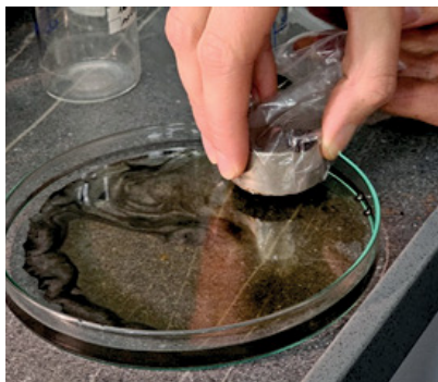
Рисунок 13. Сбор нефти наночастицами магнетит@ОК (олеиновая кислота)
