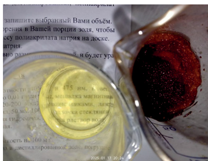
Рисунок 5. Полиакрилатный гель, полученный из золя наносеребра
